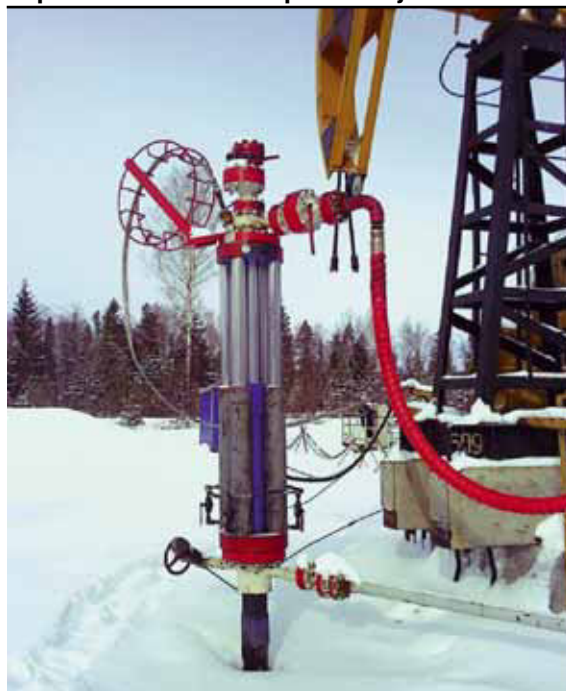
Рис. 1. Однолифтовая установка для ОРЭ с ЭЦН с гидроприводом на устье, управляющим положением переключателя потоков через колонну НКТ
